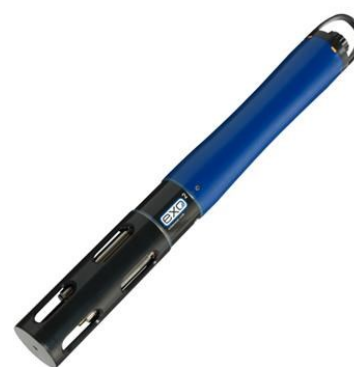
Bilde 6 Multisonde; exo2 ( https://www.ysi.com/EXO2 )
