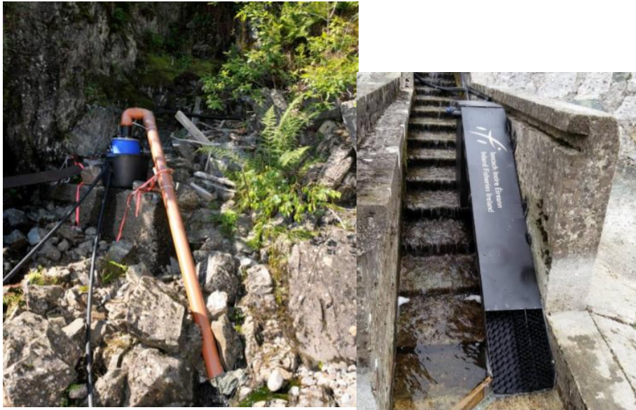
Figur 14. Foto av en ålefelle bygget av 220l fat, PVC-rør og emkamat (venstre). Foto fra Frode Kroglund. Foto av ålefelle med oppgangsstige kledd i knotteplast (høyre). Foto fra European eel foundation (2022).
